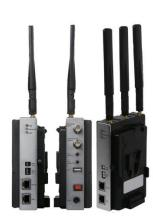
EQUIPO CAPAZ DE CODIFICAR Y DECODIFICAR SEÑAL DE VIDEO FULL HD HASTA 1080P/60 HD-SDI EN MODO INÁLAMBRICO O BAJO REDES IP, CON BAJA VELOCIDAD DE DATOS Y BAJO RETARDO (TIEMPO REAL). CAPACIDAD DE REALIZAR STREAMING HACIA PC, TABLET O SMART PHONE, CON ILIMITADO NÚMERO DE USUARIOS VIA RTSP (MULTICAST IP).
