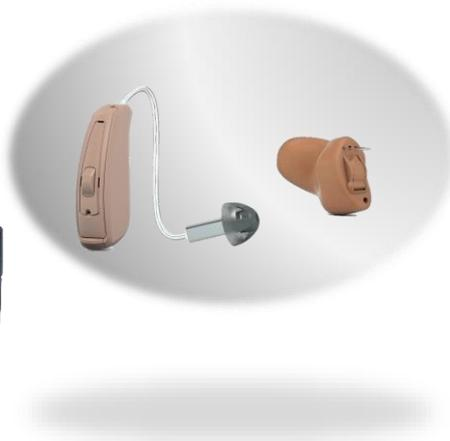
NESO 2.4 es un sistema de transmisión de audio digital para aplicaciones de monitorización de uso en TV, platós, regiduría, teatro, técnicos, etc. El sistema NESO 2.4 consiste en una estación base de radiofrecuencia trabajando en la banda ISM de 2,4 GHz y una serie de terminales auditivos tanto “intra” como “extra”-auriculares, enfocado todo ello a la transmisión/recepción de audio de alta calidad para aplicaciones profesionales. El sistema es configurable en fábrica.
